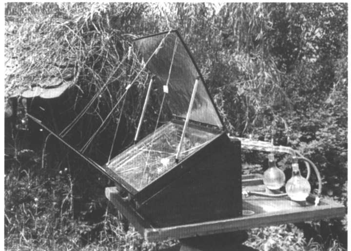
Abb. 2: Kleinerer Sonnenofen in der Größe eines Tischgerätes; links: die Sonnenspiegel werden im passenden Winkel aufgestellt; rechts: an der Rückwand treten die Kühler aus, das Hydrolyat tropft in die Gefäße, das ätherische Öl schwimmt oben.
